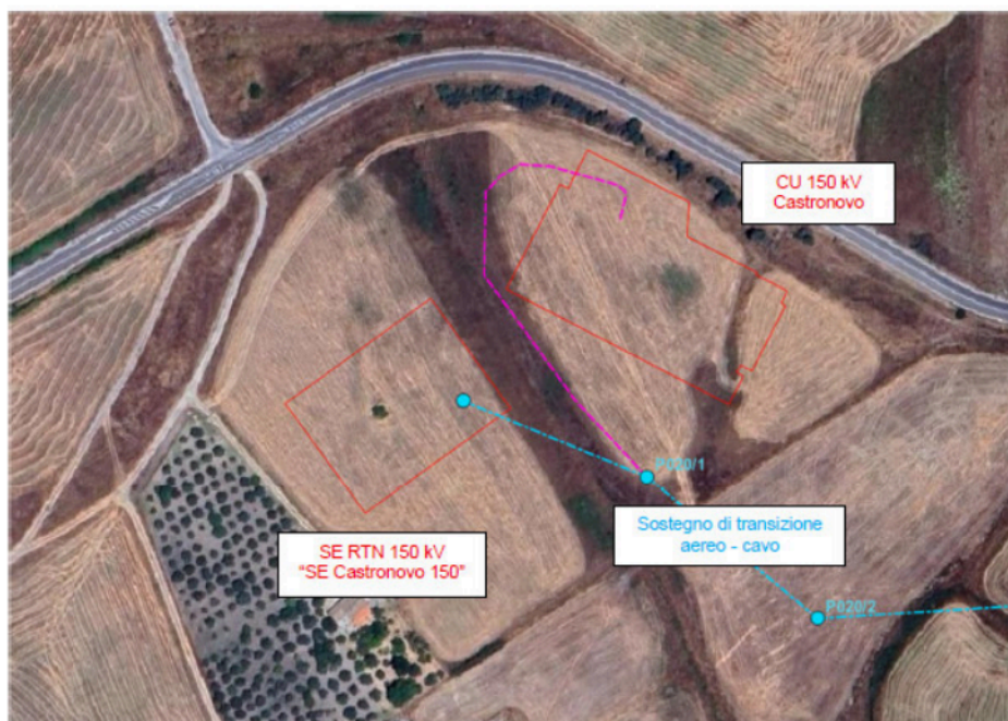
Figura 3 – Dettaglio su palo di transizione aereo-cavo e cavidotto AT
