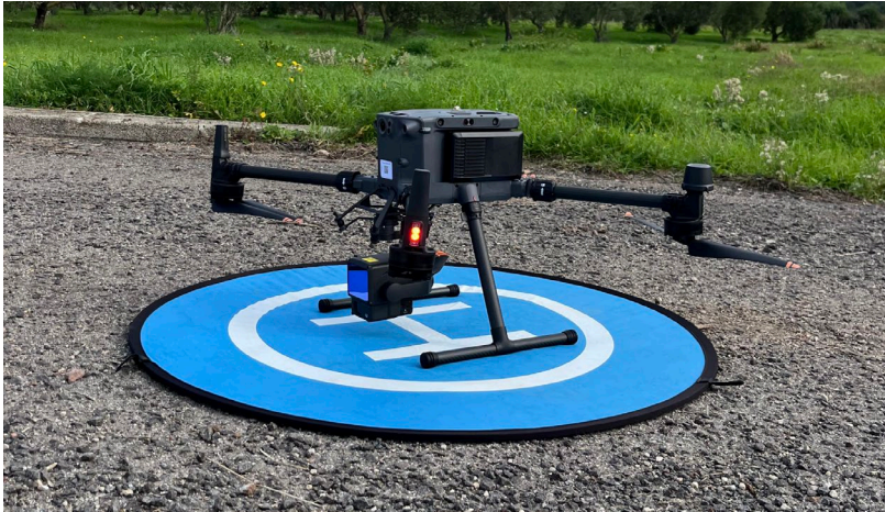
L'UAS utilizzato per l'attività di rilievo nello scenario di riferimento è il Matrice 350 RTK dotato di sensore LiDAR L2.
