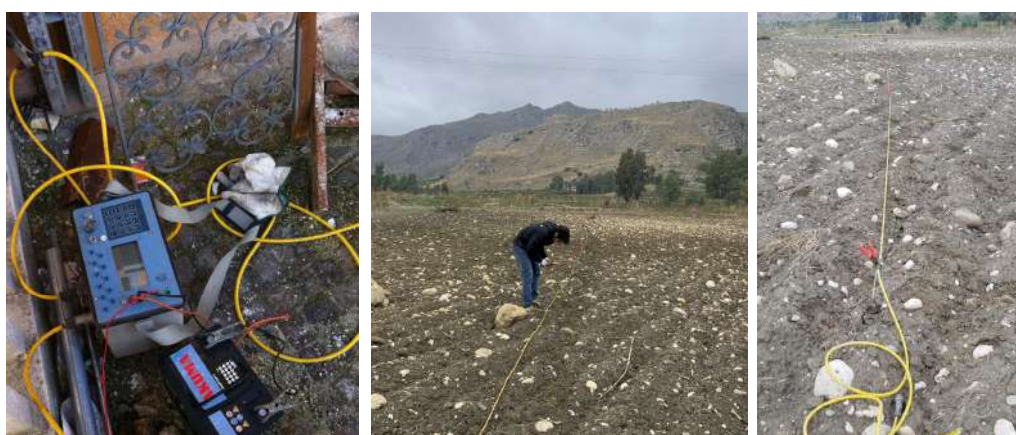
Figura 3: georesistivimetro IRIS SYSCAL PRO; immagini modalità operative tomografia elettrica 2D eseguita in sito
