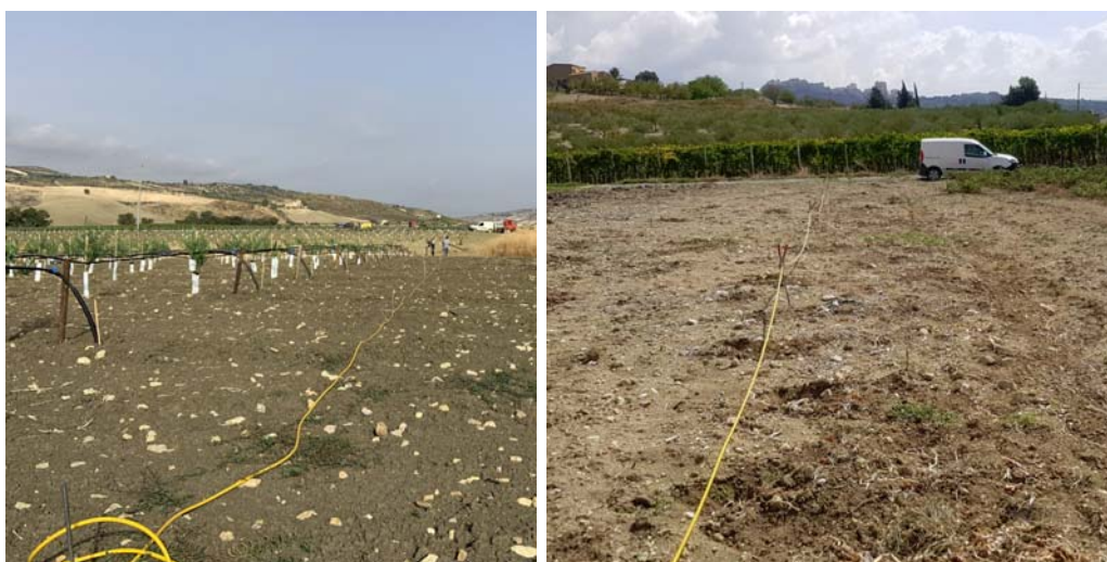
Figura 2: georesistivimetro IRIS SYSCAL PRO; immagini modalità operative tomografia elettrica 2D eseguita in sito
