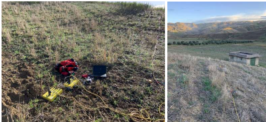
Figura 4: sismografo Daqlink III; immagine modalità esecutive tomografia sismica 2D eseguita in sito
