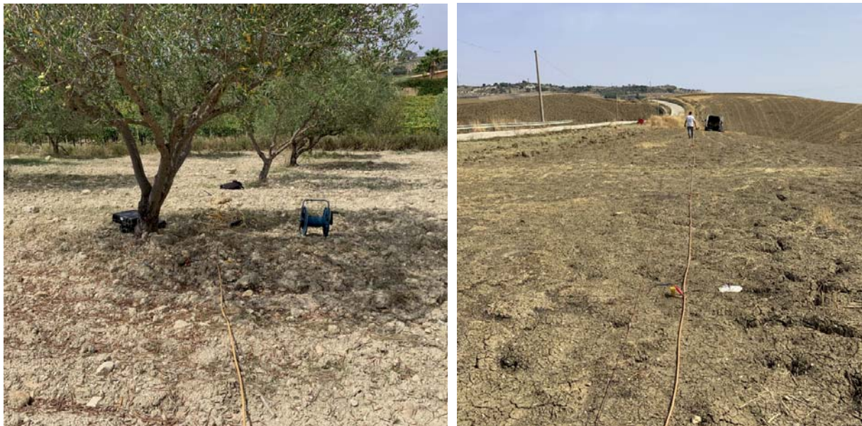
Figura 3: sismografo Daqlink III; immagine modalità esecutive tomografia sismica 2D eseguita in sito
