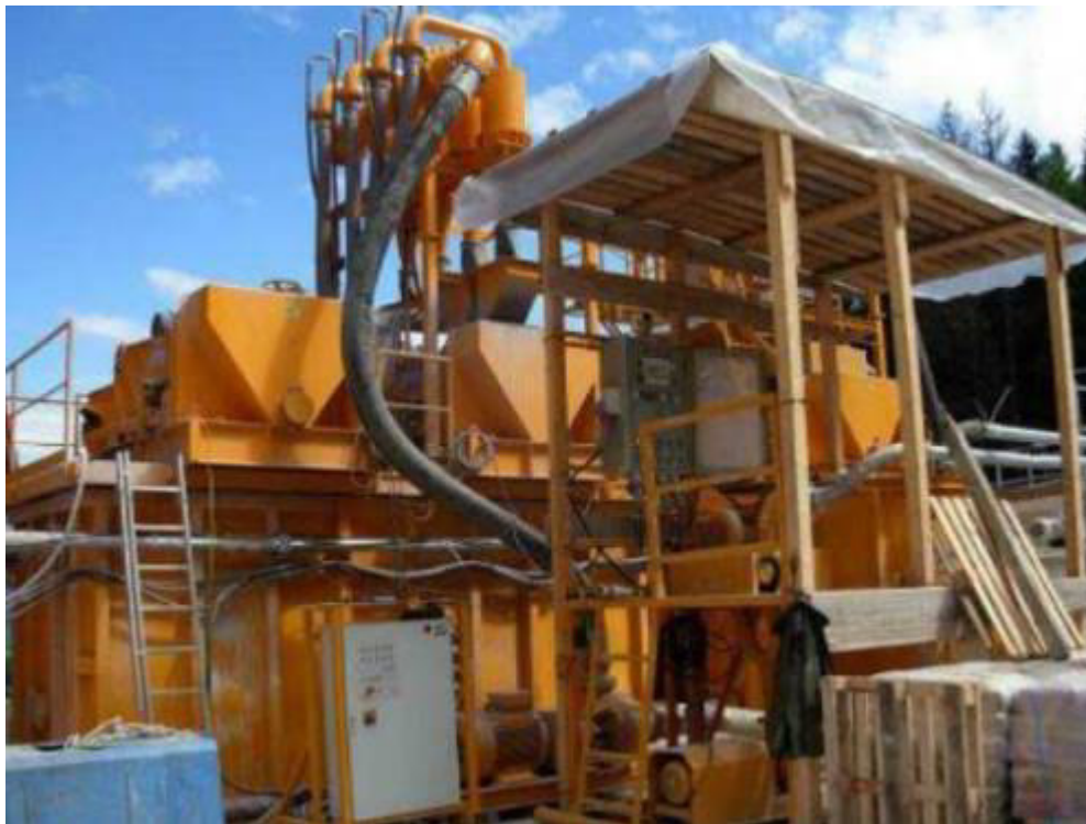
Foto 3.2.2/D Sistema di disidratazione
