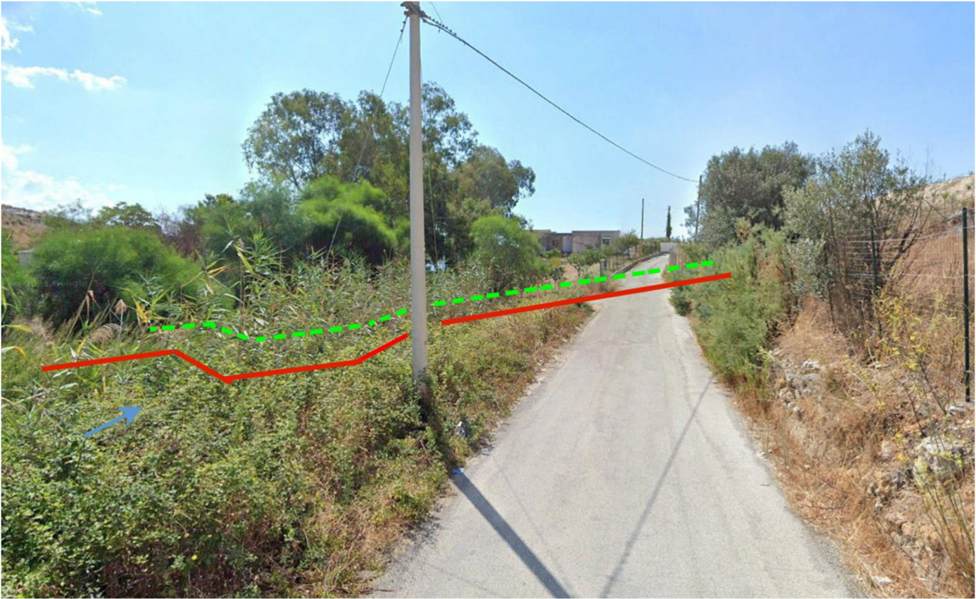
Il fosso nel punto di attraversamento (in rosso la linea in progetto e in verde la dismissione)
