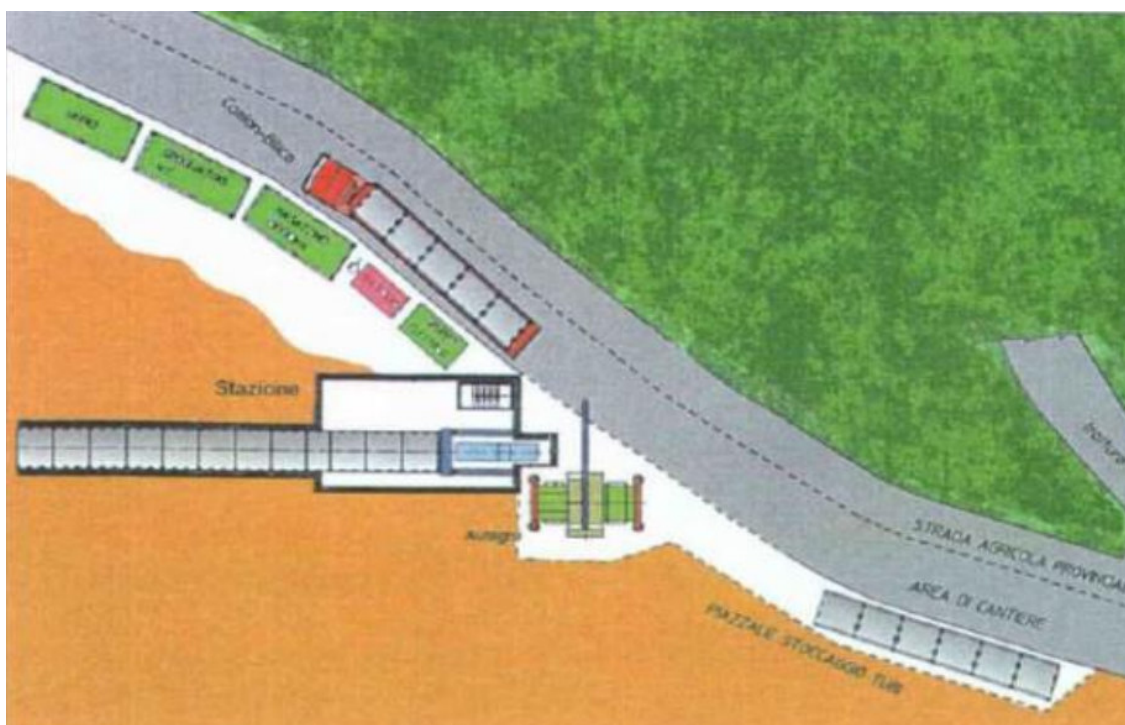
Fig. 5.1.12/C - Schema tipo di un cantiere per l'installazione di un microtunnel
