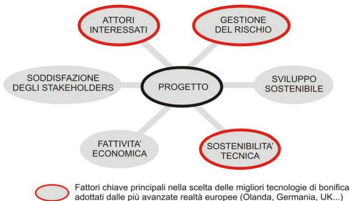
Fig. 7.2: Fattori che concorrono alla scelta della tecnologia di bonifica
